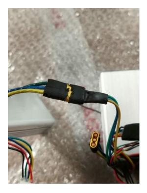
Débrancher ainsi les fiches pour les rebrancher directement sur la nouvelle box CDI.
