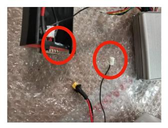
Débrancher le câble de l'ancienne box CDI pour brancher le câble de la nouvelle box CDI.
