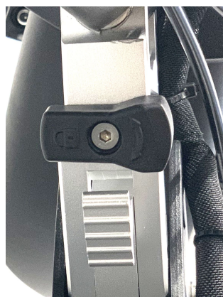
pliage déverrouillé conduite interdite
