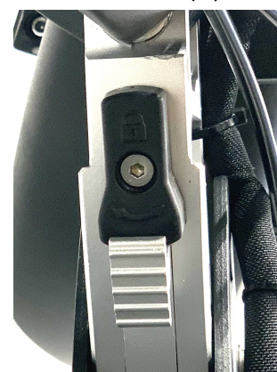
pliage verrouillé conduite sécurisée
