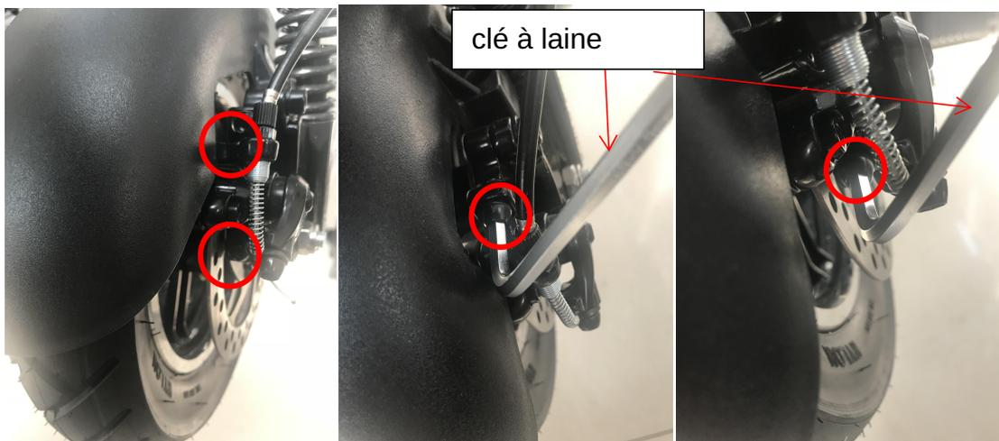
3/ Ajustez la position du disque de frein avec la main gauche, tournez la roue avant avec la main droite, en même temps écoutez le son ou regardez l'écart entre la roue et le disque de frein et le frein à pied qui sont situés dans les deux sens du disque de frein. Jusqu'à ce que vous trouvez la bonne position du disque où vous ne pouvez plus entendre le frottement du frein.
