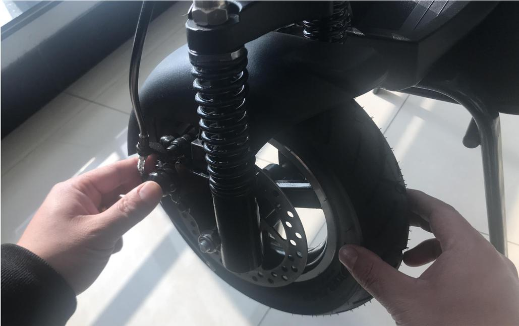
4/ Maintenez votre main gauche, utilisez votre main droite pour prendre la clé à laine de 5 mm et resserrer les deux vis dans le sens d'une aiguille d'une montre.
