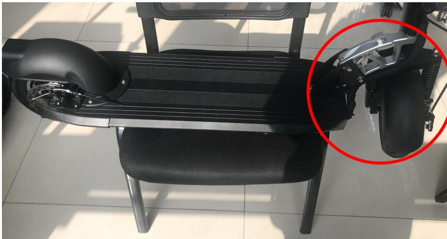
2/ Trouvez les deux vis de réglage pour le disque de frein avant,
