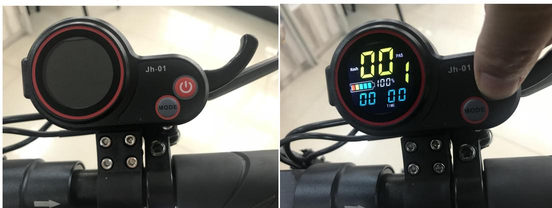
2. Appuyez simultanément sur le bouton ON / OFF et le bouton MODE, l'écran suivant apparaîtra.
