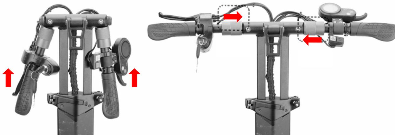
Ajustez la hauteur du guidon, et verrouillez les deux colliers de serrage.
