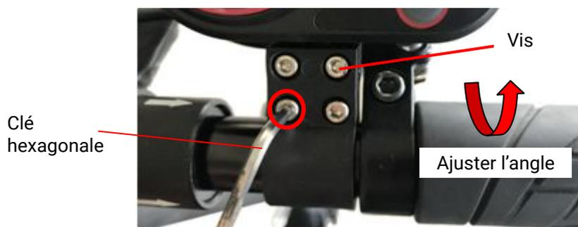
Positionnez la commande pour qu'elle soit facilement accessible par votre index. La commande doit être collée à l'extrémité de la poignée pour ne pas gêner le pliage des poignées.
