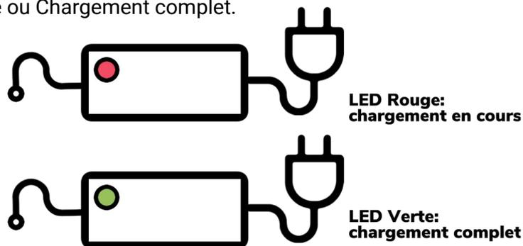
Wegoboard fournit un chargeur dédié doté d'une fonction de protection qui coupe automatiquement le chargement une fois la batterie complètement chargée. Malgré le chargement complet déjà effectif, une longue période de chargement, peut endommager la batterie en affectant sa durée de vie. Il est impératif d'arrêter le chargement dès le chargement complet (le voyant de charge passant au Vert).
