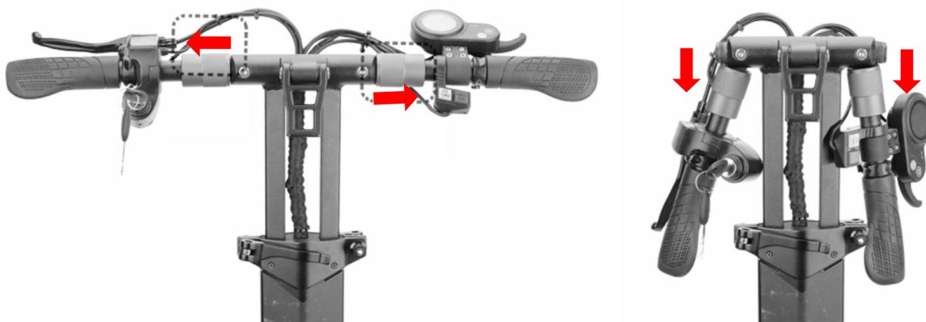
Déverrouillez les 2 colliers de serrage pour baisser le guidon et clipsez le crochet de pliage (a) . Vérifiez bien que le crochet de pliage (a) soit bloqué avant de soulever la trottinette.
