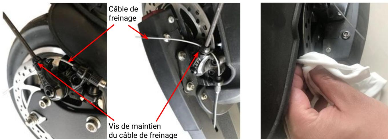
Si vous entendez un sifflement aigu lorsque vous freinez : préparer un chiffon propre et sec et nettoyez le disque de freinage.
