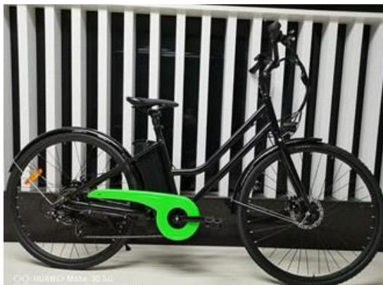
**Semestriel** - Retirer et nettoyer, lubrifier chaîne, engrenages de dérailleur et tous les câbles. Vérifiez et remplacez si nécessaire.
