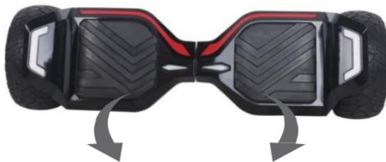
Une pression sur le pied droit en avant vous permettra de tourner à gauche, pour tourner à droite, appuyez sur le pied gauche
