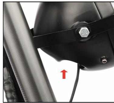
Débranchez le connecteur puis bien remettre les cables dans la trappe.
