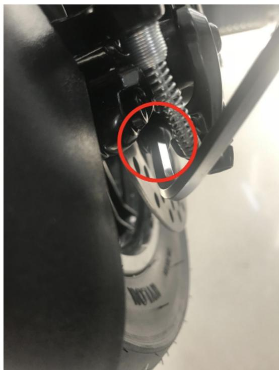
Tournez à nouveau la roue avant pour vérifier le bruit du frein. S'il n'y a plus de bruit de frein ou si le bruit est faible, vous pouvez déduire que l'ajustement du bruit est réglé. Réitérer s'il y a encore beaucoup de bruit.
