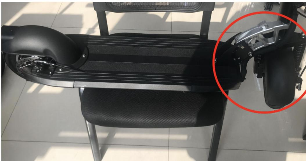
Trouvez les deux vis de réglage pour le disque de frein avant,
