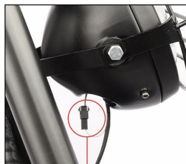
Dans le boîtier LED Avant, sortez le câble de la trappe.
