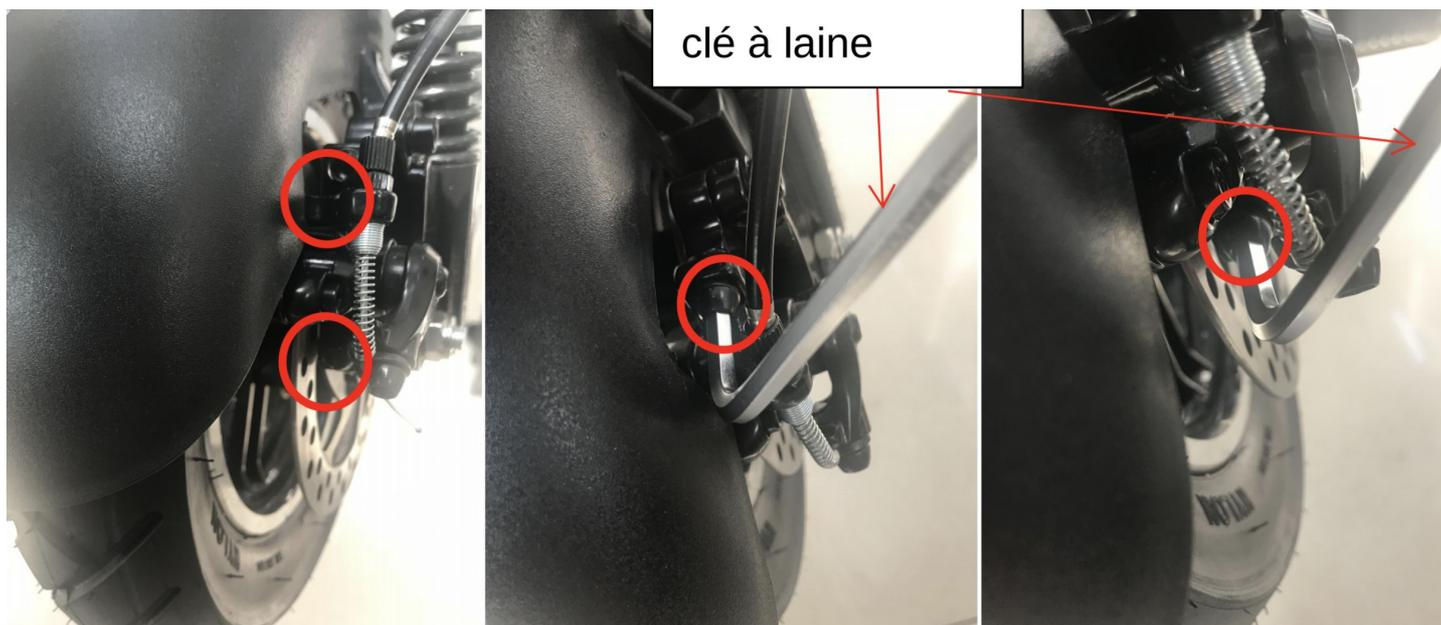
Ajustez la position du disque de frein avec la main gauche,
