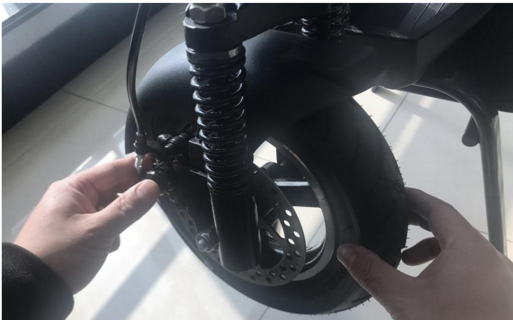
Maintenez votre main gauche, utilisez votre main droite pour prendre la clé à laine et resserrez les deux vis dans le sens d'une aiguille d'une montre.
