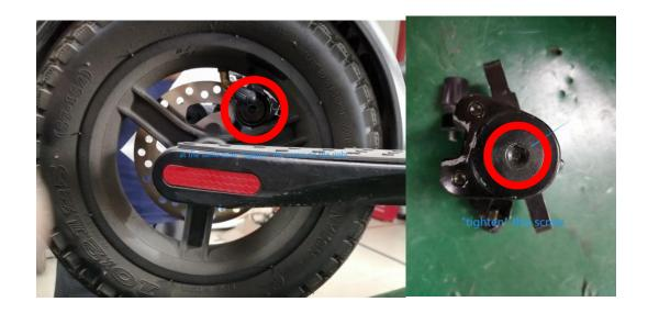
**Etape 3 :**Si le disque frotte le côté droit en faisant du bruit, vous devez régler le côté droit pour le réajuster
