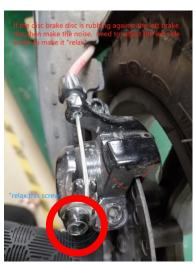
Desserrez légèrement la vis de la photo de gauche ci-dessus (desserrez un peu le câble de frein) en même temps serrez la vis de la photo de droite ci-dessous.
