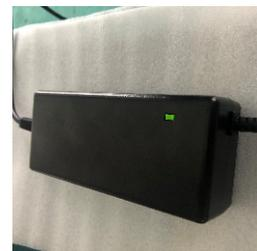
Après la charge, débranchez d'abord la fiche d'entrée (de la sortie), puis débranchez le connecteur de sortie (du vélo). Le chargeur de batterie doit avoir une tension constante. Une tension fluctuante ou une alimentation électrique fluctuante de tout type peut endommager les cellules de stockage de la batterie.
